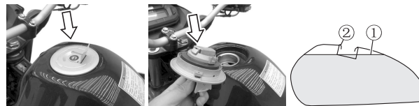
① Niveau de carburant ② Réservoir de carburant
